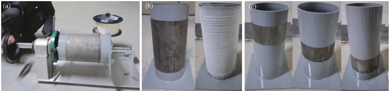
图 3 光纤环绕装置及试样制作图。(a)光纤环绕装置;(b)试样 A 制作;(c)试样 B 制作
