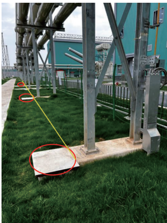
图 5 WFBG 静力水准仪与应变传感光缆布设图
